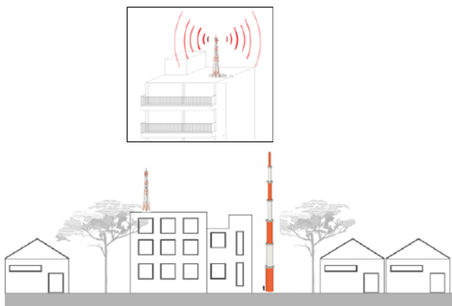
Ilustración 3. Estructura en azotea y torre auto soportada
