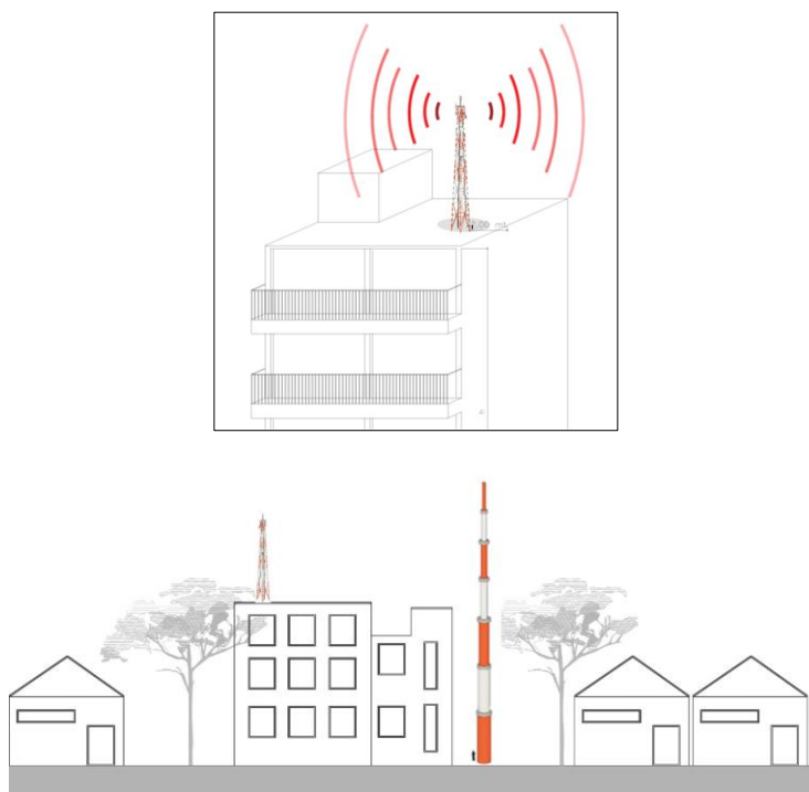
Ilustración 3. Estructura en azotea y torre auto soportada
