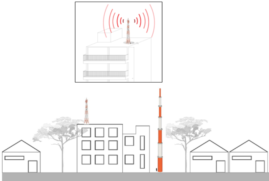
Ilustración 3. Estructura en azotea y torre auto soportada
