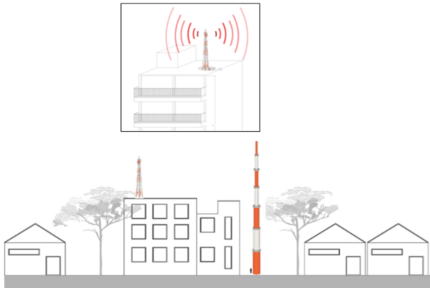
Ilustración 3. Estructura en azotea y torre auto soportada
