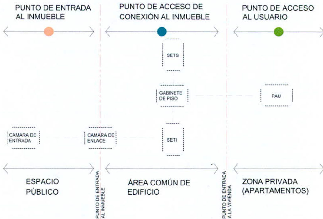
Gráfica 1. Esquema general de una red interna de telecomunicaciones
