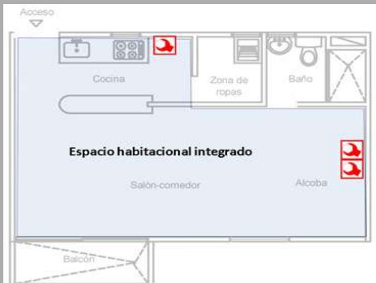
Ilustración 20. ubicación de las cajas de toma de usuario en una vivienda de hasta 135 SMMLV tipo aparta estudio de un solo ambiente. Fuente: Propia.
