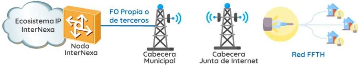
**Tipo 4.** Junta de Internet conectada vía Microondas y usuarios redes punto multi punto
